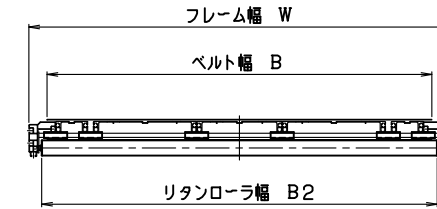
中間断面図 V 様2条 (B=1100, 1200)
